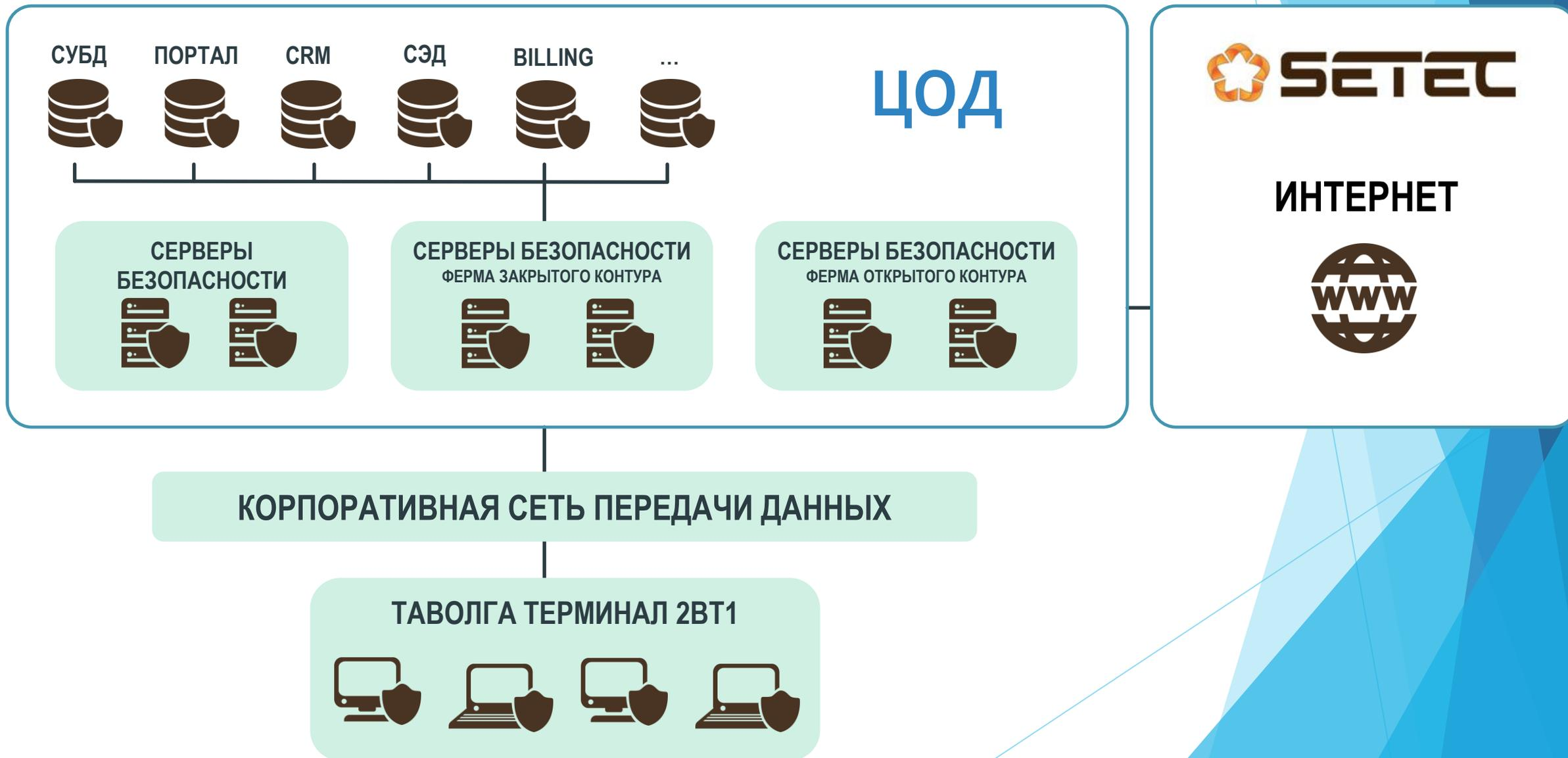
**Решение на основе российского компьютера «Таволга Терминал 2BT1» и клиентской части отечественной универсальной системы защищенного электронного обмена Терминал CyberFT.**
